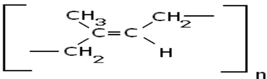
Гуттаперчу применяют как изолирующий материал в электро- и радиопромышленности, в химической и обувной промышленности, а также в стоматологии как материал для пломбирования корневых каналов, а также при изготовлении зубных протезов.
