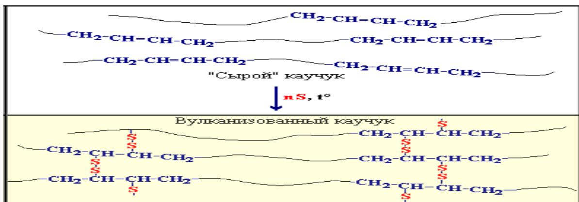
Сетчатый полимер более прочен и проявляет повышенную упругость – высокоэластичность (способность к высоким обратимым деформациям). К основным свойствам резины относятся: прочность, эластичность, износостойкость, твердость. В зависимости от количества сшивающего агента (серы) можно получать сетки с различной частотой сшивки.
